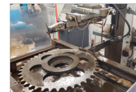
Рез звездочки цепной передачи на станке М 800.
