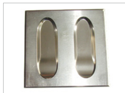
Изготовление пресс-формы подошвы с шероховатостью Ra0,2.
