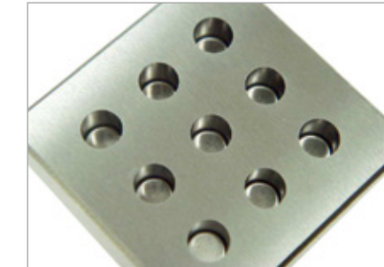
Прожиг матрицы отверстий диаметром 10 мм, глубина 10 мм, шероховатость Ra0,15.
