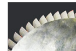
Материал: SKD11. Толщина: 80 мм. Ra: 1,0 мкм. Проходы: 3. Точность: 0,008 мм. Время: 10 ч.
