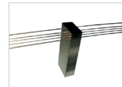
Отверстия диаметром 0,4 мм в заготовке из нержавеющей стали толщиной 10 мм.
