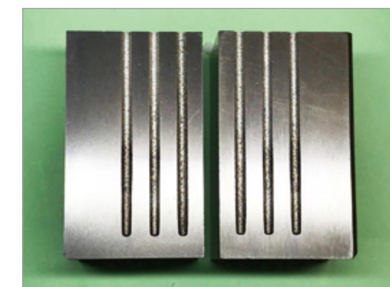
Разрез образца сверления заготовки из нержавеющей стали электродом 1,0 мм на глубину 40 мм.
