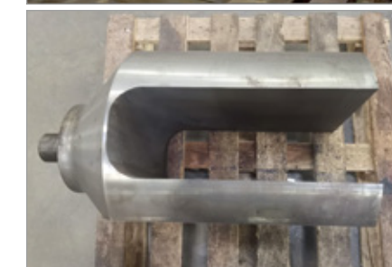
Рез детали-проушина на станке М 550. Сталь 35. Габариты: 450 x 150 x 360 мм.
